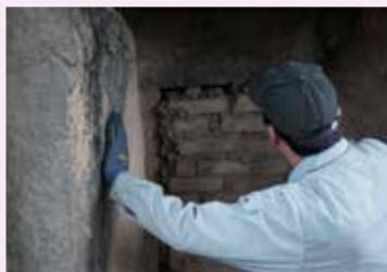
窯を閉めて酸欠状態にし、窯内の火を鎮火させ、炭を冷却。3日間の火入れの後、この冷却が4～5日ほど行われる。今西家は「くど」と呼ぶが、「くどさし」ともいう。
