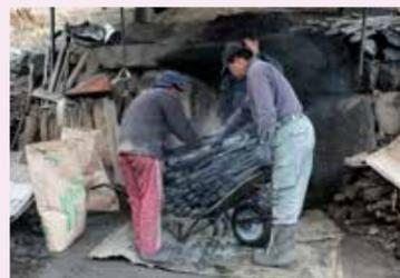
炭を窯から取り出していく作業。くどで冷却したとはいえ窯の中はまだ80度以上。かなりの重労働かつ危険な作業でもある。
